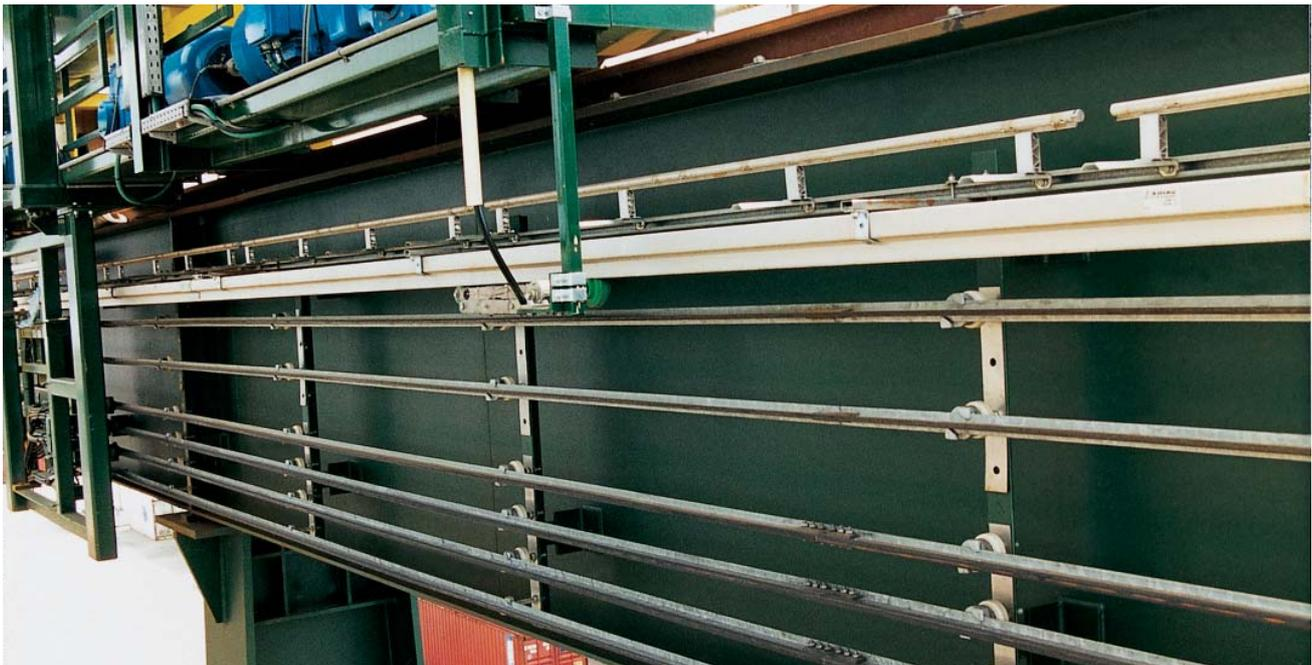
Antennenführung SMG-RAE-XY-6 im Einsatz bei einem Großkran.
